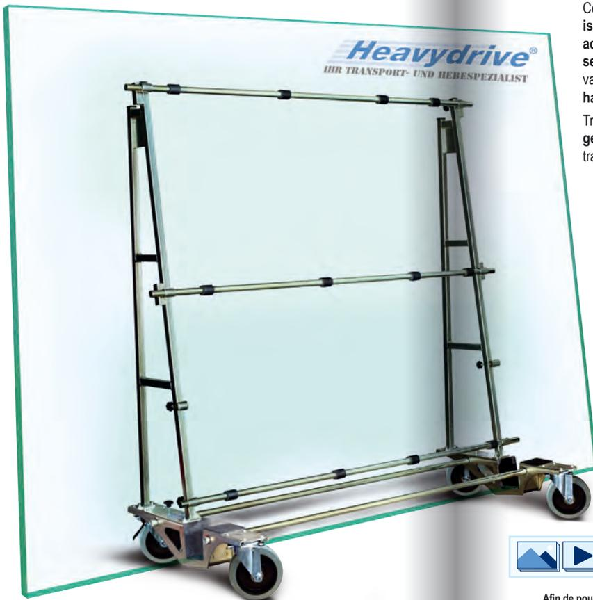
Ce chariot-porte vitres permet de faire passer les triples vitrages isolants encombrants jusqu'à 700 kg par les portes et d'autres accès étroits et se dirige très facilement en n'employant qu'un seul opérateur. Ce chevalet porte-vitres s'adapte de manière variable aux vitres de toutes les dimensions, jusqu'à 4 m de hauteur et 3,2 m de largeur.
