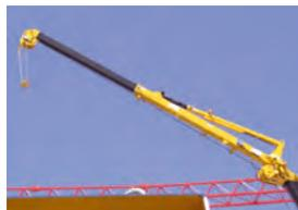
Embout charges lourdes, capacité de charge jusqu'à 400 kg, extensible jusqu'à 4,1 m
