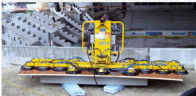
**Ventouse spéciale pour surfaces rugueuses telles que les plaques de pierre épaisses, les panneaux en plastique, le béton, les surfaces gravées, les panneaux en bois, les panneaux de contreplaqué et bien plus encore.**
