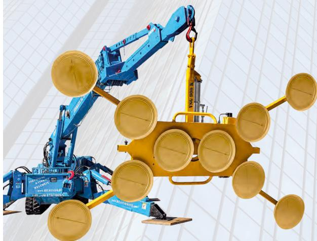
Pose de vitres parfaite également derrière les échafaudages grâce à la conception ultra mince d'une profondeur de 160 mm seulement !
