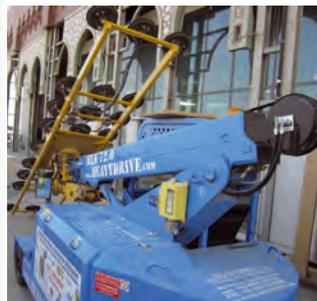
La grue industrielle MLK 72.0 avec manipulateur 4 axes pose les vitres triangulaires et trapézoïdales jusqu'à 1 800 kg
