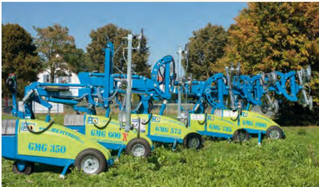
Cet équipement de pose compact et mobile transporte et pose avec précision millimétrique les vitres jusqu'à un poids de 1 000 kilos.
