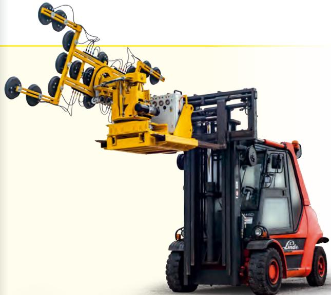
Manipulateur 7 axes télécommandé à monter sur chariot télescopique pour intérieur voire pour extérieur.
