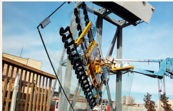
**VSGU** - Manipulateur 3 axes pour manutention aérienne pour mini-grue voire grue de chargement sur châssis pour vitres légères, capacité de charge jusqu'à 600 kg
