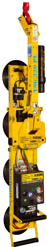
Modèle universel pour vitres de parois et de toit de 2,5 m de large sur 3 m de long d'un poids jusqu'à 320 kg, fonctionnement à batterie.
