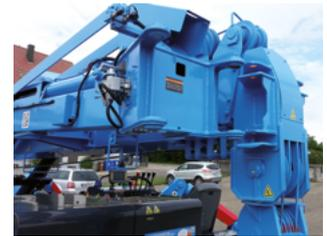
Hydraulische Spitze seitlich montiert
