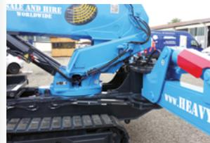
Abstützung hydraulisch ausklappen
