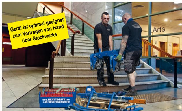
Der KGK ist komplett zerlegbar. So kann er platzsparend transportiert oder mit 1 oder 2 Personen problemlos z. B. über Stockwerke versetzt werden, ohne einen Kran zu benötigen. Besonders hilfreich ist das, wenn auf der Baustelle kein Kran mehr zur Verfügung steht. Der KGK ist auch bei von aussen schlecht zugänglichen Gebäuden optimal einsatzfähig.
