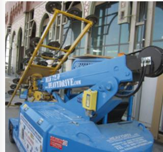
Der Industriekran MLK 72.0 mit 4-Achsen-Manipulator, der die dreieckigen und trapezförmigen Glasscheiben bis zu 1800 kg setzt
