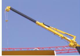
**Schwerlastspitze bis 400 kg Traglast, ausziehbar auf 4,1 m**
