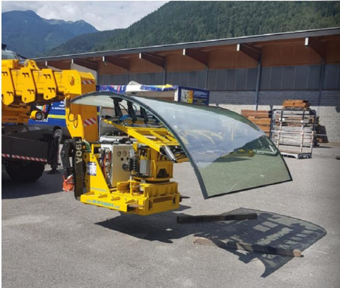
7 Achsen-Manipulator mit Fernsteuerung zur Aufnahme mit einem Hallen- bzw. Gelände-Teleskopstapler.
