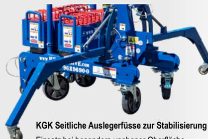
KGK seitliche Auslegerfüsse zur Stabilisierung im Gelände
