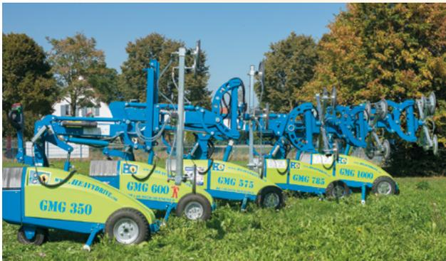
Der kompakte mobile Montagehelfer transportiert und setzt mm-genau Scheiben mit einer Traglast bis zu 1.000 Kilo.
