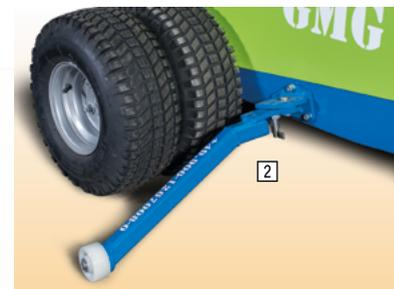
Seitliche Kippsicherung zum sicheren Verfahren im Gelände
