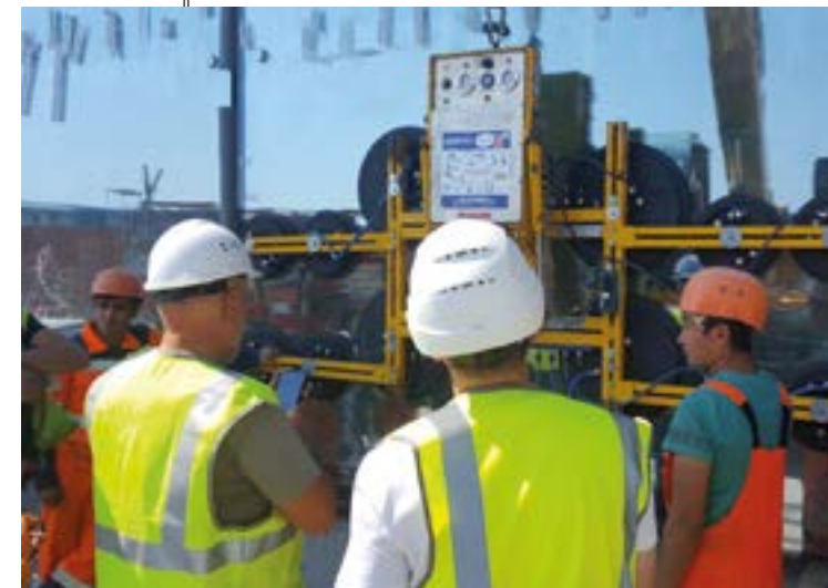
Einweisung vor Ort: Vakuum-Sauganlage VSG 1500 KH
