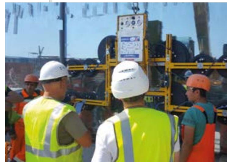
Instructaj la fața locului: Instalație de aspirare cu vid VSG 1500 KH
