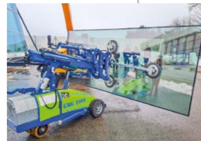
Echipament de montare sticlă GMG 1000
